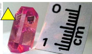
Ist er dotiert, kann er rot werden und erhält neue Eigenschaften: ein Doppel-Wolframat-Kristall.
