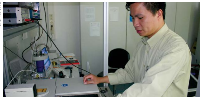
Der vietnamesische Forscher Tran Tien Quoc steht am Spektrometer, mit dem die Eigenschaften von Laserdioden gemessen werden.
